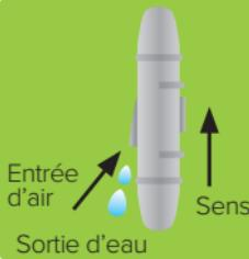
Le dispositif de rupture de siphon doit être positionné plus haut que le niveau d'eau du réservoir.
